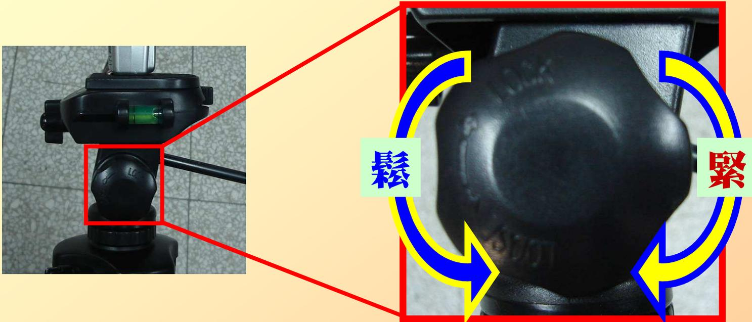
將控制旋鈕**逆時針旋轉**，可**放鬆固定器**；**順時針旋轉**則可將固定器**鎖緊**。一般拍照時，於調整確定後須鎖緊，若為**拍攝影片時**，因須跟隨拍攝擺動，可稍微轉鬆，以便拍攝，事後仍須鎖緊。
