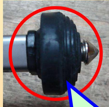
將底部的橡膠**旋入**後，會露出**金屬**固定點，**適用於一般的草地或泥沙地**。
