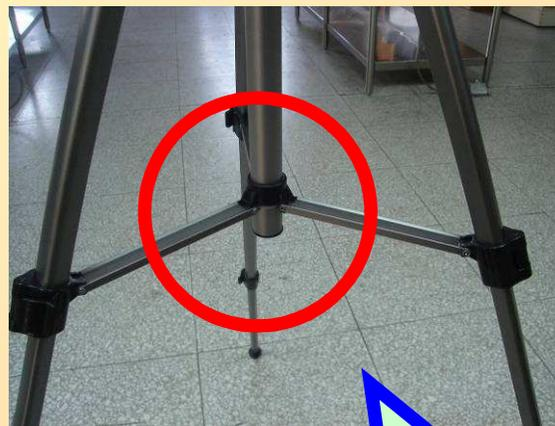
調整好長度後，將腳架打開，必須將中間的固定點調至底端，才能穩固。
