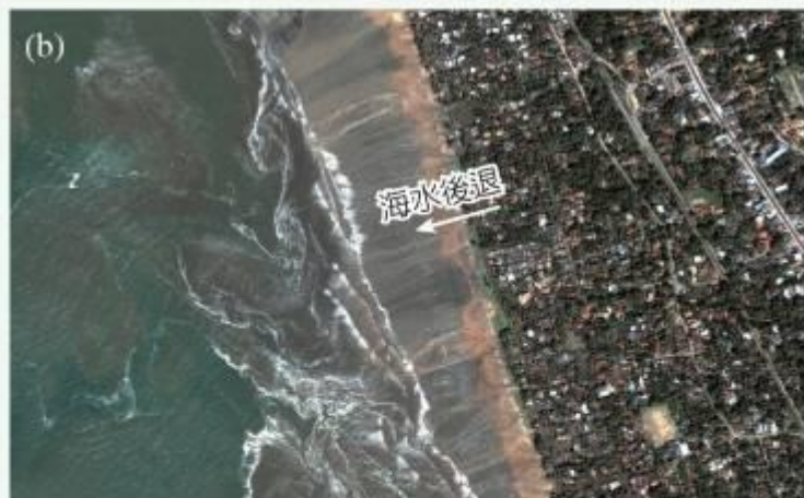
圖 7-31 斯里蘭卡 Kalutara 海岸在南亞海嘯發生前後的變化。(a)2004 年 1 月海嘯發生前，(b)2004 年 12 月 26 日海嘯發生時，波谷先到達，海水後退約 400 公尺。
